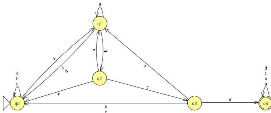
Para provar que não existe AF com 4 estados, basta aplicar o algoritmo de minimização ao autômato acima e constatar que ele coincide com o autômato mínimo. Uma outra forma é constatar, por inspeção visual, que os estados deste autômato não são equivalentes:
